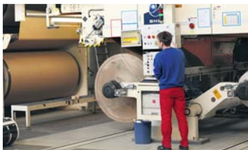
Leitstand der Wellpappeanlage: Mitarbeiter Markus Kather steuert von hier aus die 240 Meter lange Anlage.
