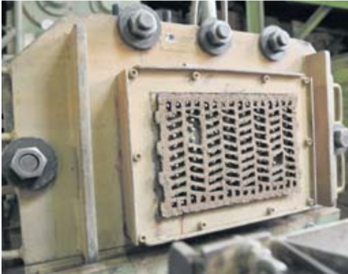
Kostet 25 000 Euro: Durch das Mundstück wird Ton gepresst.
