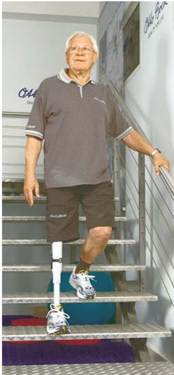
Das weltweit erste vollständig mikroprozessor-gesteuerte Beinprothesensystem C-Leg ermöglicht unter anderem, in alternierenden Schritten treppab zu gehen.
